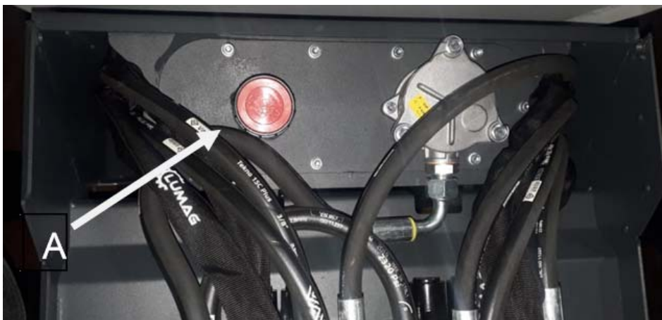
Hydrauliköltank / Verschlusskappe (A)
