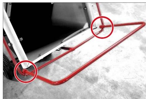
NOT-HALT Bügel montieren
