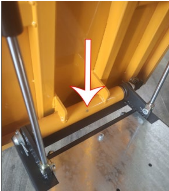
Den Schmiernippel alle 20 Betriebsstunden nachschmieren.
