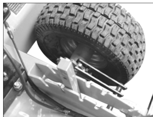
Geblocktes Laufrad mit der Fallklinke bei Frästiefeneinstellungen von 1 - 4 (MIN. - MAX.).
