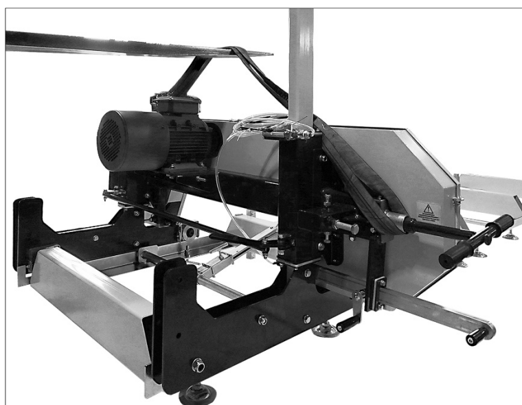
Sägekopf mit Fahrgestell auf den Schienenweg ablegen, Abbildung BSW-76GL
